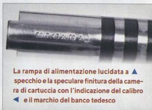
La rampa di alimentazione lucidata a ▲ specchio e la speculare finitura della camera di cartuccia con l'indicazione del calibro ◀ e il marchio del banco tedesco
