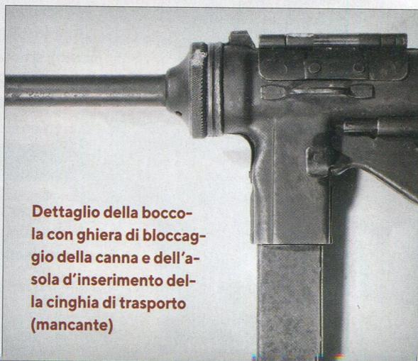
Dettaglio della boccola con ghiera di bloccaggio della canna e dell'assola d'inserimento della cinghia di trasporto (mancante)
