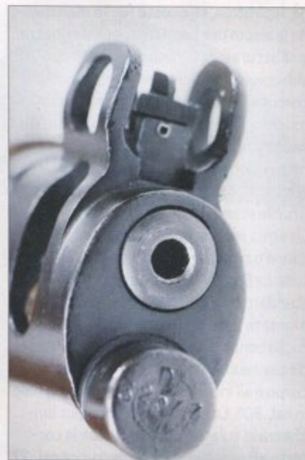
▲ L'emblematico e classico vivo di volata degli Smle N° 1 Mk III* riportato sul modello in cal. 22 Lr
