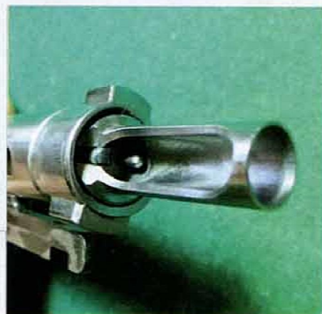
Particolari dell'otturatore con la culla designata a ospitare la piccola munizione rimfire
