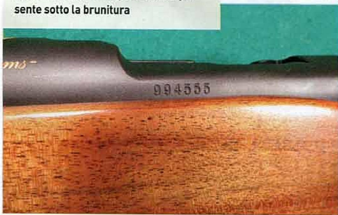
Particolare del numero di matricola (appartenente ad un K31 in 7,5 fabbricato nel 1963) e alla "P" marchio di privatizzazione dell'epoca ancora presente sotto la brunitura
