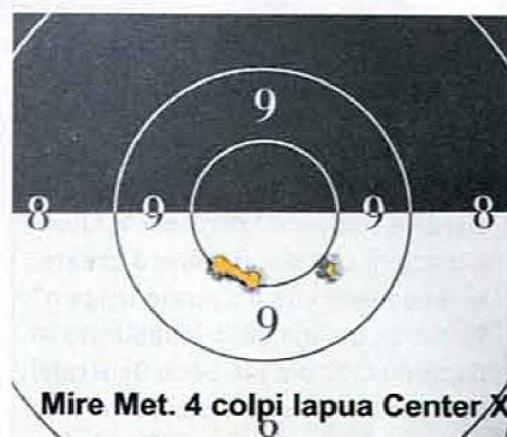
Arma con sole mire metalliche: rosata di 4 colpi on Le Lapua Center X di soli 22 mm
