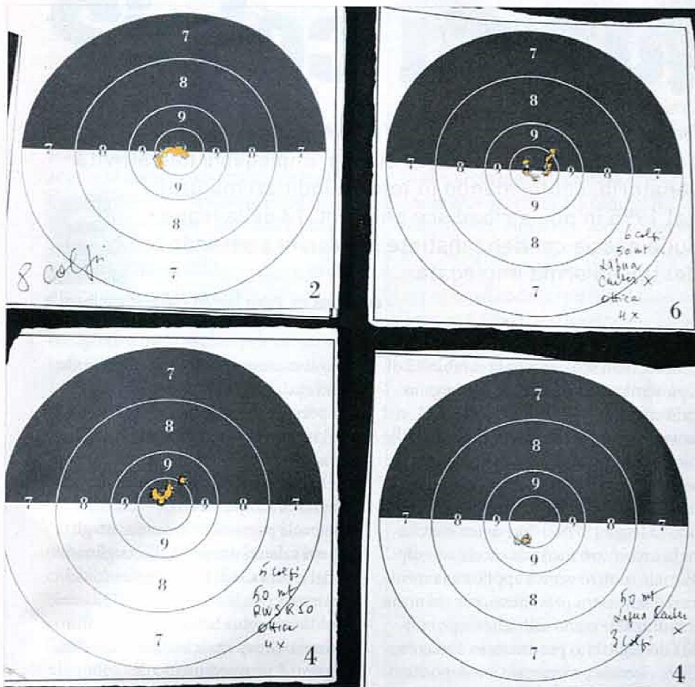
Rosate con ottica montata: con le RWS R50 abbiamo realizzato una rosata di 8 colpi nel 10 del bersaglio di 18 mm da centro a centro visibile nel barilotto in alto a sinistra. Seguono: nel barilotto in alto a destra, la rosata di 6 colpi con le Lapua Center X mantenutasi in 20 mm
