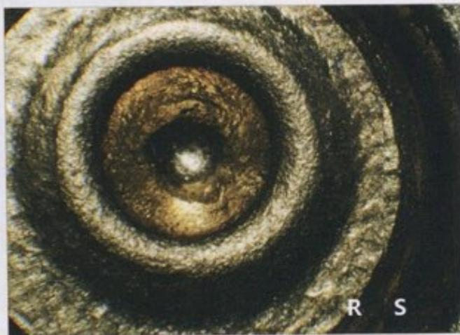
▲ Accostamento e comparazione positiva di eloquenti coincidenze sul cielo dell'innesco tra "R" e "S" ▲
