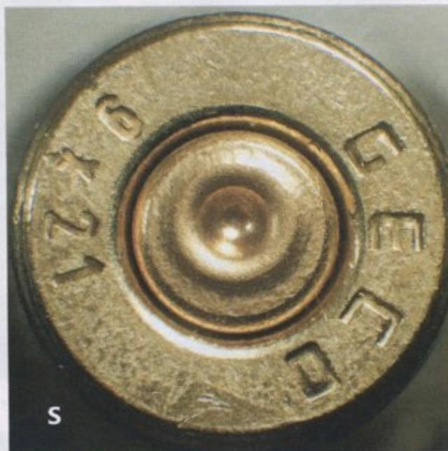
◀ Il fondello del bossolo del secondo test, eseguito con cartuccia originale della stessa marca e tipo di una di quelle a reperto (C5); tale test è indicato con S. L'impronta d'espulsione, seppur simile, non è della medesima coincidenza di quelle residue sulle cartucce in sequestro
