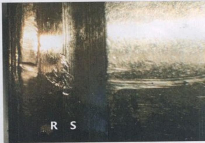
▲ Visibili, in accostamento e in comparazione, le impronte d'estrazione presenti sotto il collarino del bossolo "R", a sinistra, rinvenuto sul teatro di un crimine e il test sperimentale "S" a destra, esploso con l'arma sospettata. Tali impronte sono state verificate solo dopo aver allineato quelle d'espulsione sui due bossoli in osservazione
