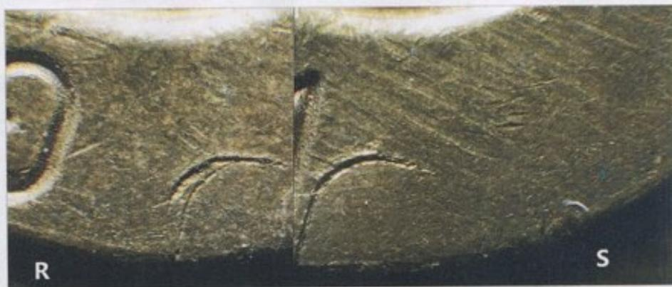
▲ Esempio di come siano visibili - a ore 6 - le impronte d'espulsione accostate tra reperto "R" a sinistra e il test sperimentale "S" a destra, esploso con l'arma sospettata
