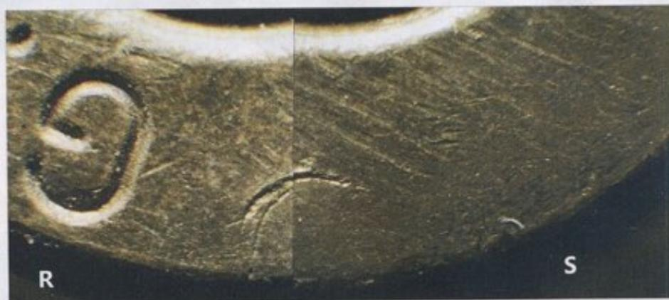
▲ Ingrandimento della comparazione positiva tra le impronte d'espulsione tra reperto "R" e il test sperimentale "S" a destra, esploso con l'arma sospettata
