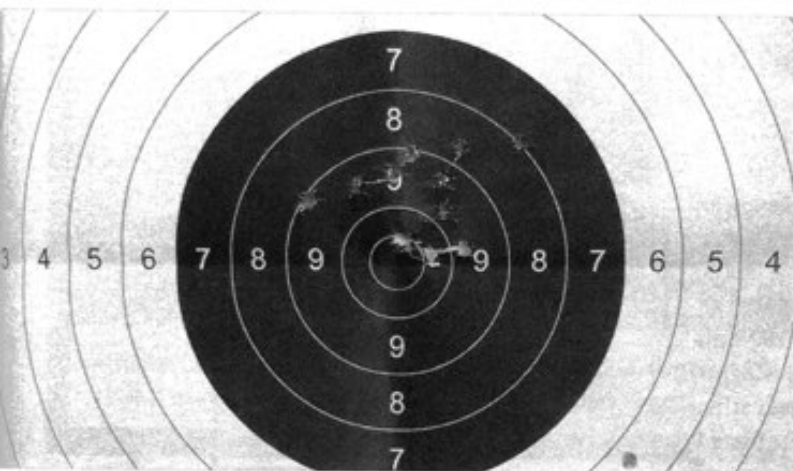
Risultati ottenuti con lo Schmidt Rubin K-31 in cal. 7,5x55 con la palla cast da 180 grani e la dose di grani 14,2 di N110
