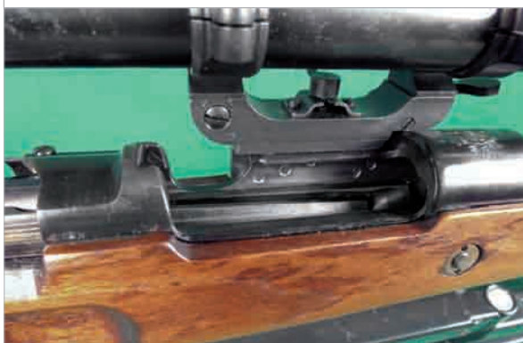
La professionale rifinitura della parte terminale delle viti dell'attacco all'interno della guida dell'otturatore
