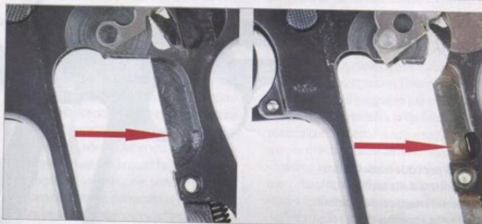
Ingrandimento dal lato destro del vano di accesso alla testa della mola del cane sul modello Zella - Mehlis Ingrandimento dal lato destro del vano di accesso alla testa della mola del cane sul modello Zella - Mehlis v
