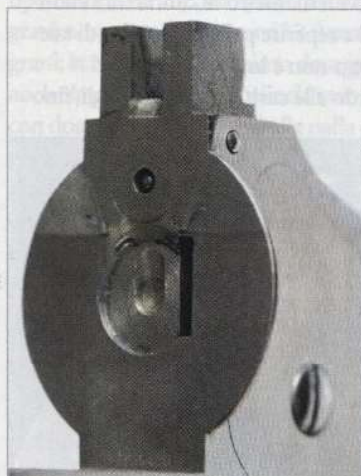
Nella porzione superiore dello scudo sono visibili i risalti di aggancio della chiave di chiusura
