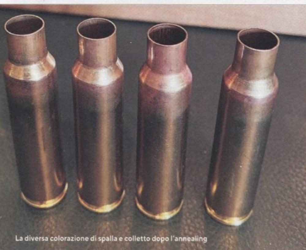
La diversa colorazione di spalla e colletto dopo l'annealing
