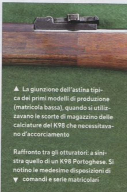
▲ La giunzione dell'astina tipica dei primi modelli di produzione (matricola bassa), quando si utilizzavano le scorte di magazzino delle calciature del K98 che necessitavano d'accorciamento
