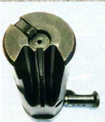
Il grosso e pesante otturatore - interamente ricavato dal pieno - con la leva di armamento dotata del sistema di blocco, fotografato da varie angolazioni
