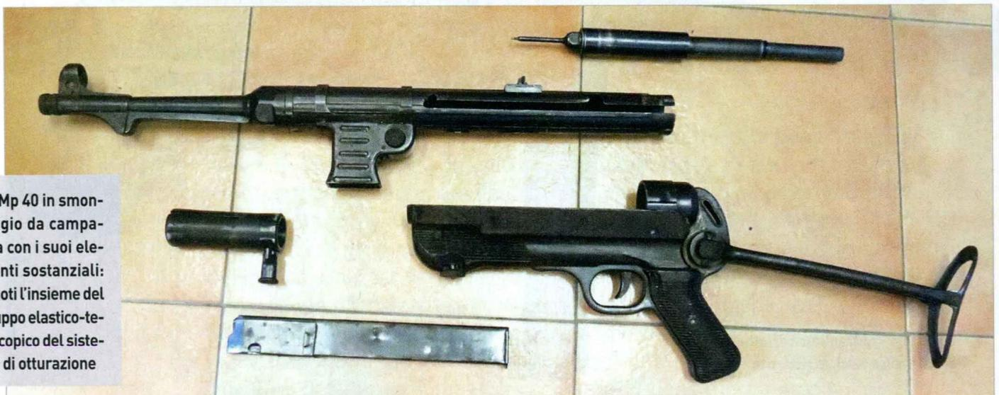
La Mp 40 in smontaggio da campagna con i suoi elementi sostanziali: si noti l'insieme del gruppo elastico-telescopico del sistema di otturazione
