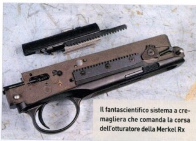
Particolare della leva d'armamento della Merkel che aziona la trazione rettilinea
