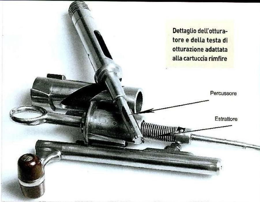
Differenze tra l'otturatore del G-1911 e quello del nostro Lienhard che è un 1889
