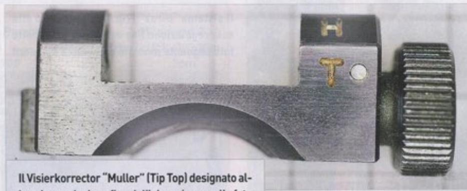
Il Visierkorrektor "Muller" (Tip Top) designato alla sola regolazione fine dell'elevazione; nella foto seguente montato sulla tacca standard
