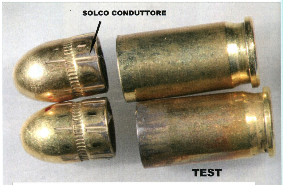
Bossoli e proiettili relativi a test: la freccia evidenzia uno dei solchi conduttori
