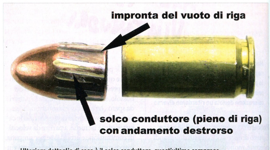
Ulteriore dettaglio di cosa è il solco conduttore, quest'ultimo compreso tra le strie primarie con, al suo interno, le strie secondarie
