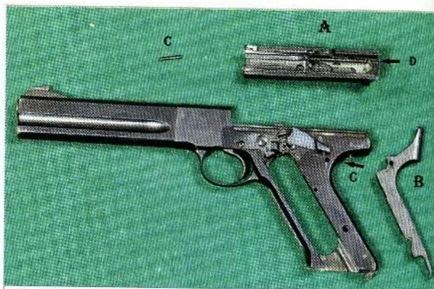
Smontando la pistola, si nota: (A) il carrello-otturatore, dove è visibile all'interno la sua molla di recupero nella massima estensione; (D) indica la piastrina di bloccaggio della testa del guidamolla comandata dal pulsante sul cielo di culatta; (B) il dorsolino in acciaio contenente la molla del cane; (C) il piccolo perno di fermo del dorsolino (la freccia indica il foro di alloggiamento nel fusto sotto la guancetta sinistra)
