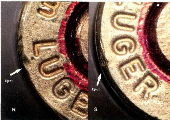
Accostamento e successiva comparazione positiva tra due bossoli cal. 9 luger si notino le differenti impronte di espulsione causate da tolleranze meccaniche dell'arma sebbene ci troviamo di fronte ad una comparazione positiva cioè il bossolo R repertato sul luogo di un ferimento è stato sparato dalla pistola che ha espulso il test (S) a destra
