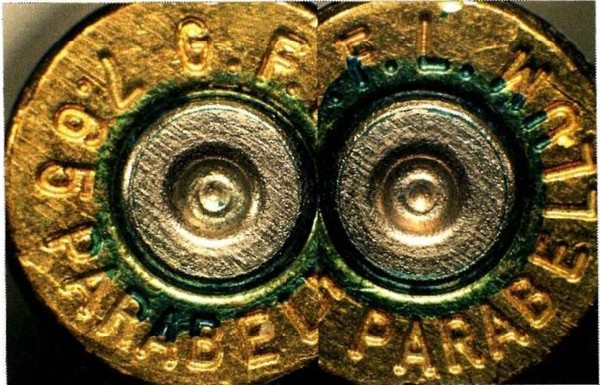
Accostamento a microscopio comparatore di due bossoli cal. 7,65 para
