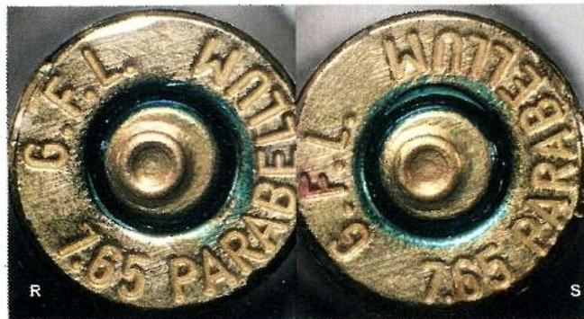
Ulteriore accostamento a microscopio comparatore di due bossoli cal. 7,65 para
