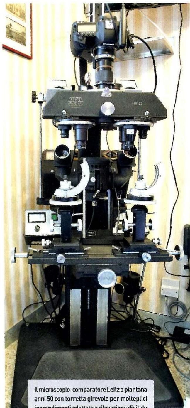
Il microscopio-comparatore Leitz a piantana anni 50 con torretta girevole per molteplici ingrandimenti adattato a rilevazione digitale
